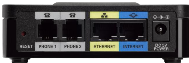
Figura 2. Puertos del ATA con router Cisco SPA122
